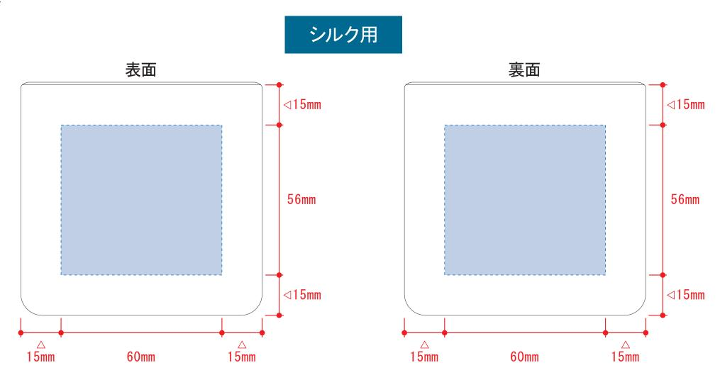
デザインスペース: W70×H66 (mm) ■シルク印刷 最大範囲: W60×H56 (mm)
